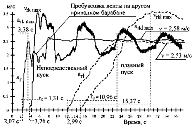
Рис. 6. Изменение скорости ленты в конвейере 3/GX на разгрузочном и хвостовом барабане во время непосредственного пуска незагруженного конвейера и плавного пуска конвейера с грузом 60,3 т
